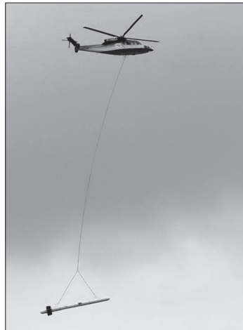
Mit einer Elektromagnetik-Sonde zieht der Hubschrauber seine Bahnen. Foto: Privat
