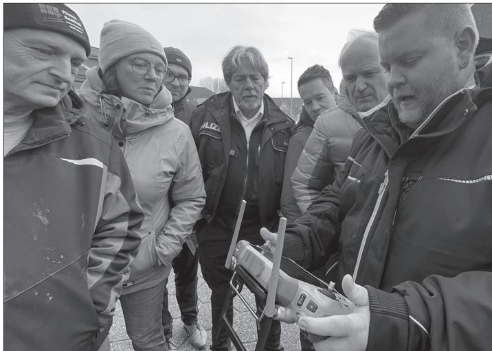
Bei der Vorführung erklärt Sven Riese, Mitarbeiter der Firma BIT Informationssysteme, die Handhabung: Mit dem Handmodul am Boden kann die hochwertige Kameraoptik der Drohne in der Luft gesteuert werden. Diese kann mit einem 42-fachen Zoom auch weit entfernte Gebäude und Areale exakt untersuchen, auch via Infrarot, beispielsweise zum Aufspüren von Brandherden. Foto: Pape
