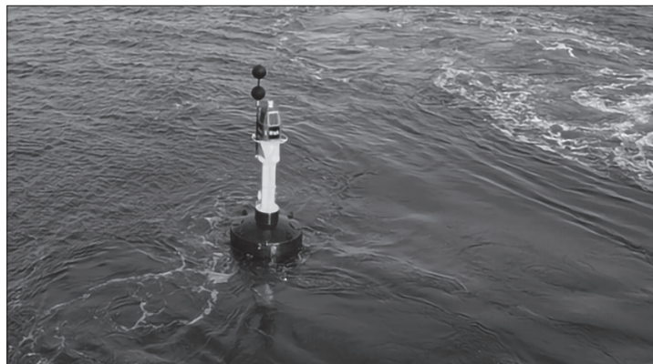
Eine ausgelegte beleuchtete Einzelgefahrtonne markiert das Wrackgebiet südwestlich der Insel Helgoland. Foto: WSV
